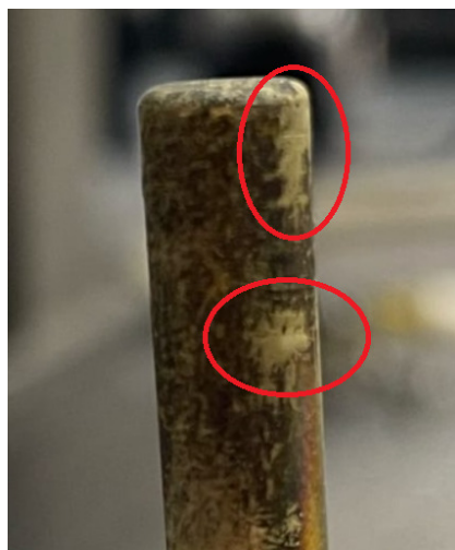
Рис.3. Поверхность катода АИПД, работающего на фторопласте, после 300 импульсов.
