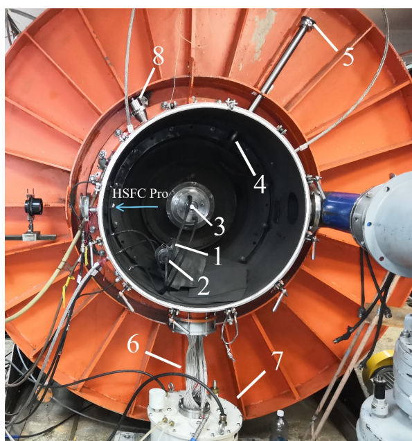
Рис.1. Фотография узла нагрузки генератора МИГ. 1 – узел нагрузки (камера) X-пинча; 2 – VRD пинча; 3 – нагрузка с обратным токопроводом генератора МИГ; 4 – набор диафрагм; 5 – фотопленка; 6 – гибкая низкоиндуктивная многокабельная линия; 7 – генератор XPG-3 X-пинча; 8 – VRD нагрузки.
